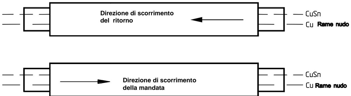
5. Nel caso di collegamento dei fili in una derivazione, connettere i cavi come di seguito illustrato per fare in modo che sia sempre il cavo di rame nudo a percorrere le derivazioni.
